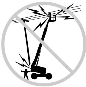
请遵循适用的政府条例和下面的表格规定，与电力线和输电装置保持安全的距离。
