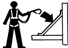
搭乘人员必须穿戴安全带或吊带，并遵循适用的政府条例。将系索钩住平台上的固定架。
